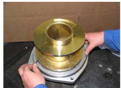
6. Setzen Sie das Spiralgehäuse über das montierte Laufrad auf den Motorflansch.
