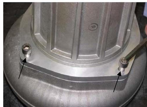
3. Entfernen Sie das Spiralgehäuse. Bei hartnäckigen Verstopfungen ist es gegebenenfalls notwendig mit Hilfe von zwei Schraubenziehern das Spiralgehäuse zu entfernen. Setzen Sie hierzu die Schraubenzieher an den beiden dafür vorgesehenen Demontageschlitzern am Spiralgehäuse an und hebeln damit das Spiralgehäuse ab.
