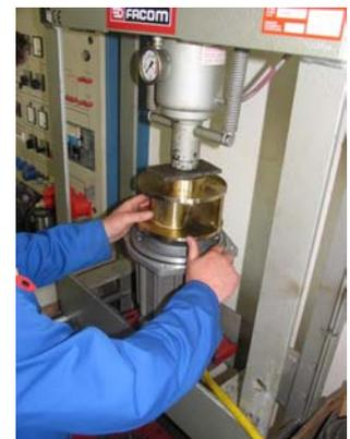
3. Das Laufrad ist bis zum Anschlag aufzupressen. (Einpresstiefe: 27 mm)
