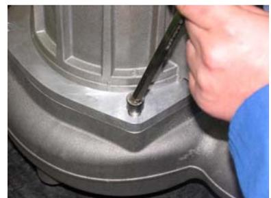
8. Setzen Sie den Tagekorb über die Pumpe und verschrauben ihn mit den sechs Zylinderschrauben mit Innensechskant (M12) mit der Pumpe (siehe Bild). Zur Sicherung der Schrauben ist mittelfeste Schraubensicherung zu verwenden.
