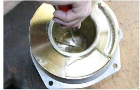
5. Benutzen Sie das als Sonderzubehör erhältliche Abziehwerkzeug, um das Laufrad von der Welle abzuziehen. Falls das Laufrad von der Welle abgezogen wird, muss der benutzte Toleranzring bei der Montage durch einen neuen Toleranzring ersetzt werden.
