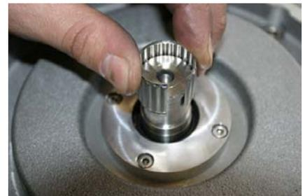
2. Setzen Sie das Laufrad gerade auf der Motorwelle auf und pressen Sie es mit Hilfe einer geeigneten Presse auf die Motorwelle auf.
