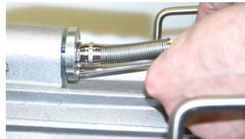
2. Ziehen Sie die Kabelverschraubung samt Stecker und Kupplung aus dem Gehäuse heraus. Öffnen Sie die Kabelsteckerverbindung und ziehen den Stecker aus der Kupplung heraus.
