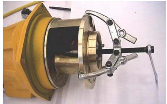
6. Entfernen Sie den benutzten Toleranzring von der Motorwelle.
